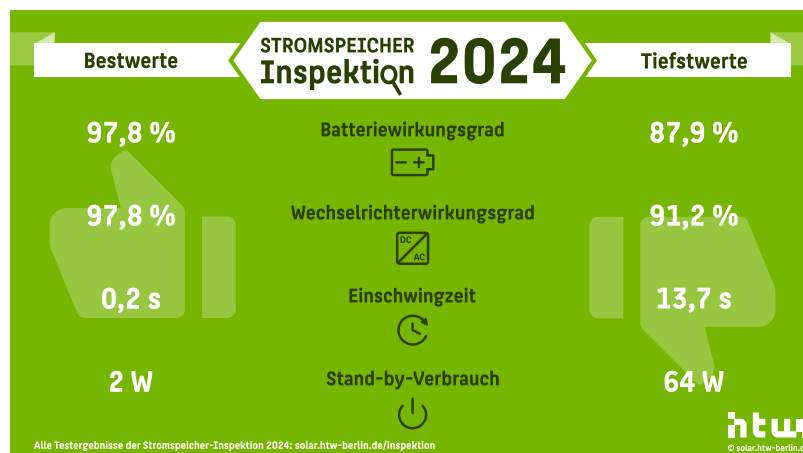
Bild 5 Bandbreite der Labortestergebnisse in der Stromspeicher-Inspektion 2024 auf Basis des Vergleichs von 20 Solarstromspeichern. Grafik: HTW Berlin.
